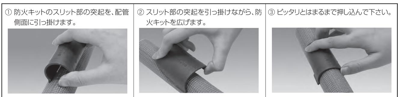
注)無理に防火キットを取付けようとすると、保温材および防火キットが破損する可能性がありますので、その場合は防火キットを一度少し広げてから取付けて下さい。
