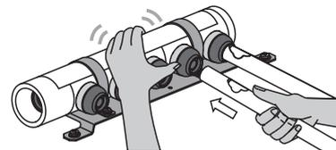
誤配管を避けるために、配管ルートを表示する表示部材があります。必要に応じてご使用下さい。
