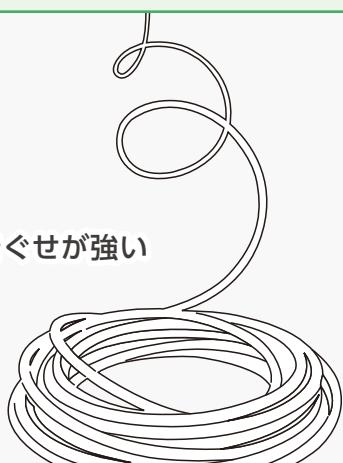
樹脂管の巻きぐせが強いと、配管を広げる際の矯正作業や、天井に固定する際の取り回しが大変。
