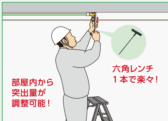
天井ボード敷設後でも、部屋内から六角レンチ1本でヘッドの突出量を調整することができ、施工性に優れています。
